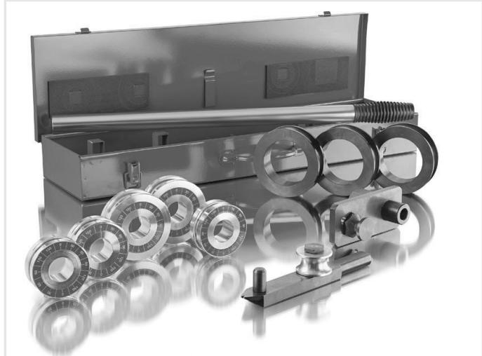
Leichtes Handbiegegerät zum Einspannen in einen Schraubstock, für präzise Rohrbögen bei Rohren von 8 bis 22 mm.
